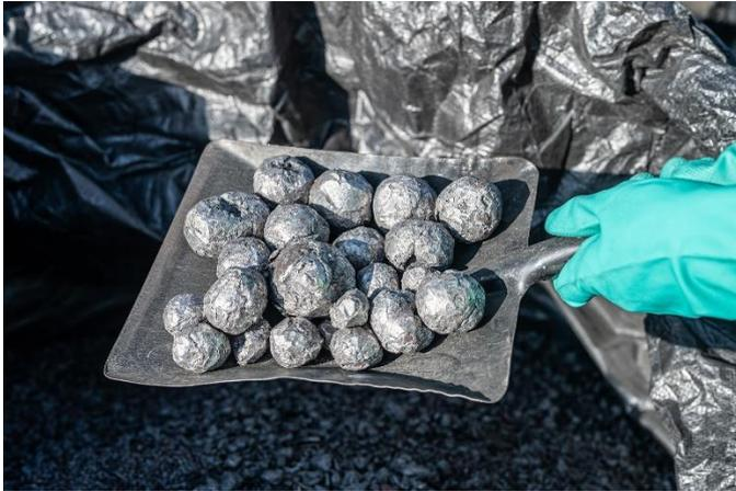
Foto 4: Recyclingprodukt aus der Verwertung von Lithium-Ionen-Batterien – Aluminium, das in seiner Qualität dem Primärrohstoff vollkommen entspricht. Fotorechte: Saubermacher.
